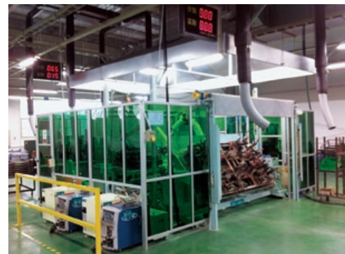
新しく導入された溶接ロボット設備。
